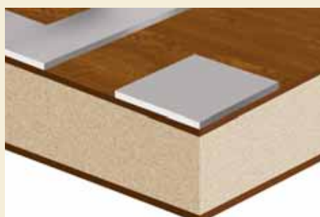
řez HPL výplně s nalepeným nerezovým rámečkem
